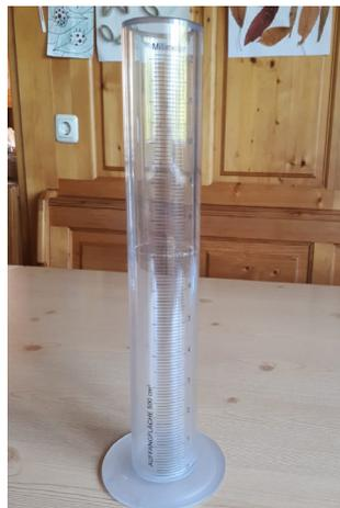
Gemessen wird der gefallene Niederschlag in mm, indem der Ombrometerinhalt in ein dafür konstruiertes Messglas umgefüllt wird, wo der Wert exakt abgelesen werden kann.
